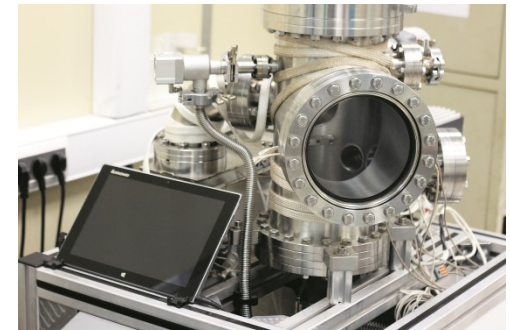
Вакуумная камера до 0,5 \times 10^{-6} мм рт. ст.
