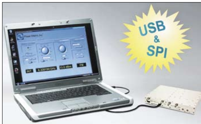
Рис. 6. Встроенный USB-интерфейс позволяет использовать QuickSyn в качестве инструментального генератора сигналов
