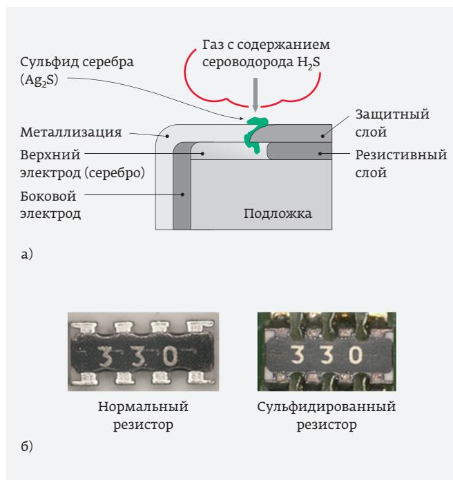
Рис. 24. Процесс осернения: а – разрез резистора; б – пример применения (данные компании Arascer)
