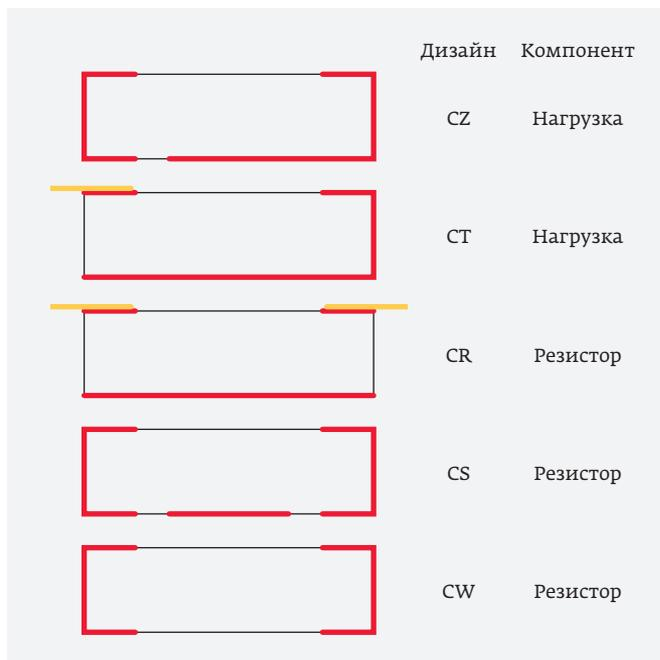
**Рис. 14.** Типы контактных площадок (данные компании АТС). Красные линии – контактные площадки, желтые – монтажные элементы типа wire bond
