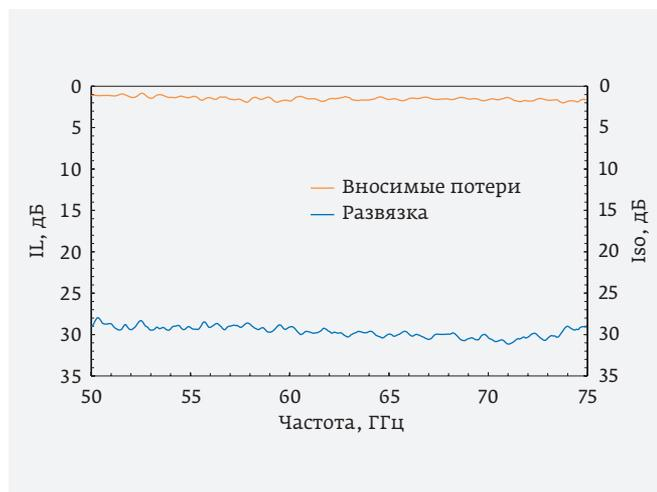
**Рис. 25.** Зависимости  $IL$  и  $I_{so}$  от частоты в волноводном рiп-диодном SPST-переключателе (модель SKS-5037533030-1515-R1, компания SAGE Millimeter)
