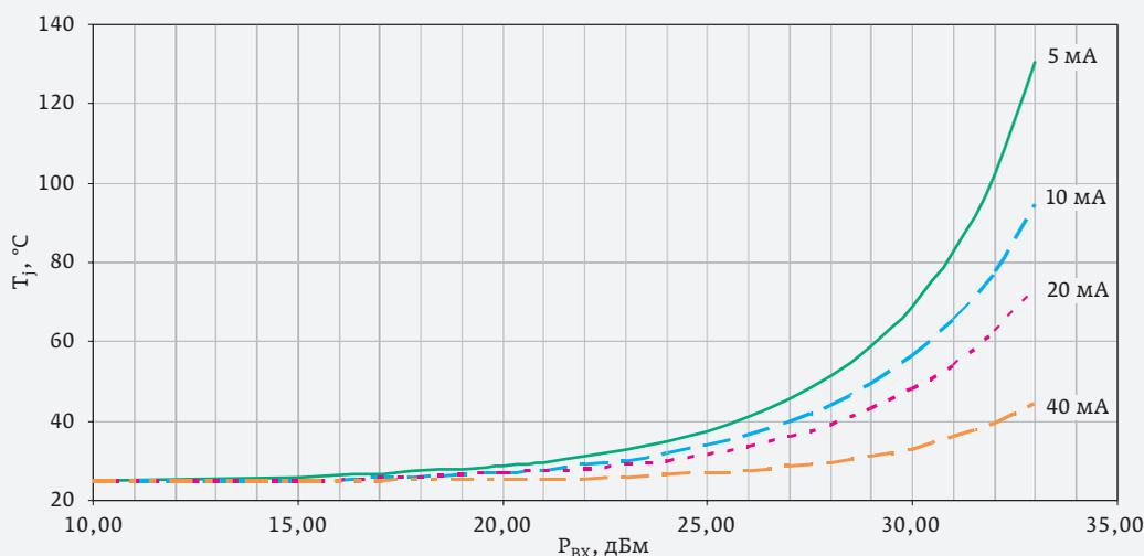
**Рис. 13.** Зависимость температуры р-п-перехода от уровня входной мощности при различных токах, протекающих через диод (модель MASW-002102-13580, компания MACOM)
