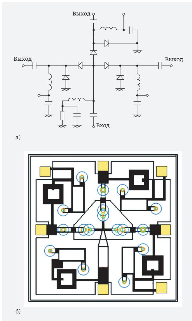
Рис. 8. Принципиальная схема (а) и топология (б) рiн-диодного SP3Т-переключателя MASW-003102-13590 (компания MACOM)
