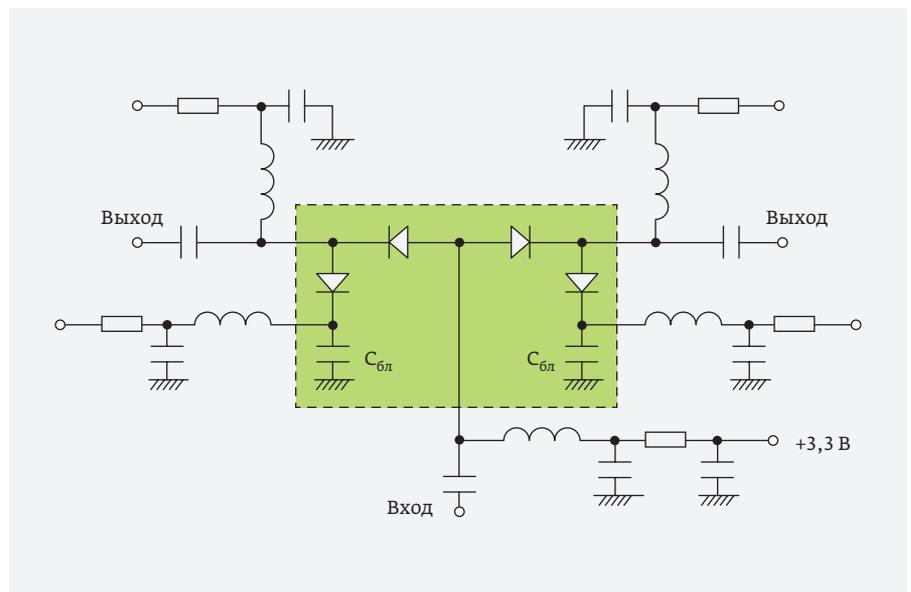
**Рис. 16.** Принципиальная схема SPDT-переключателя (модель KS113-52 компании KCB Solutions). Зеленым фоном выделена интегральная часть изделия
