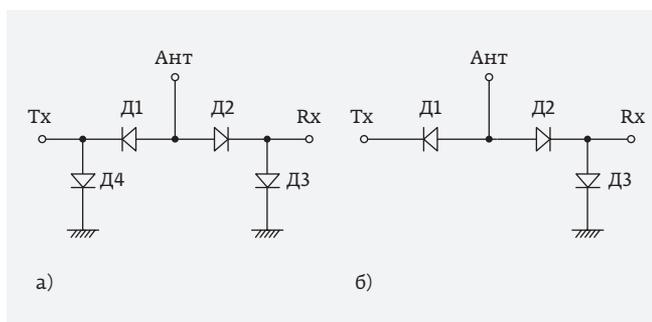
Рис. 5. Типы рпн-диодных SPDT-переключателей: а – симметричный; б – асимметричный
