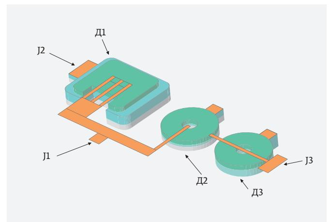
Рис. 9. Упрощенная конструкция рiн-диодного переключателя большой (1000 Вт) мощности, реализованного по технологии HMIC (компания MACOM). J1 – вход, J2, J3 – выходы
